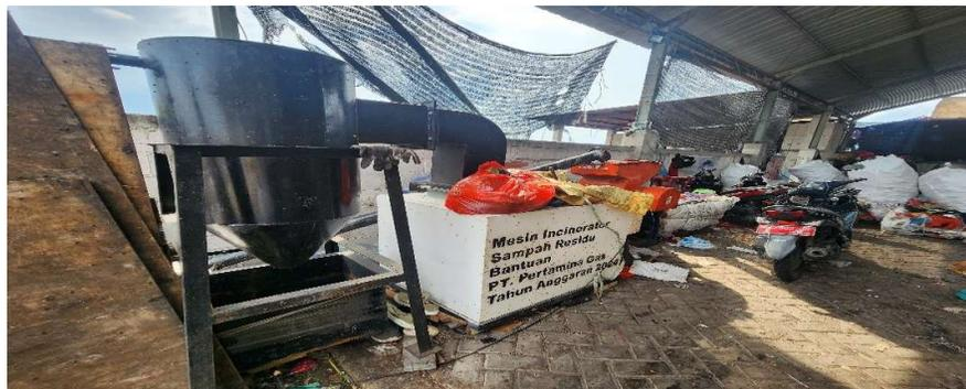
Gambar 6. Peralatan Incenerator Kapasitas Pembakaran 20 Kg sampah/30 menit (Sumber: Dokumentasi Observasi Lapangan 2024)
