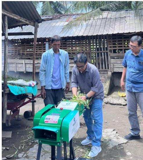
Gambar 1. Tim PKM POLMED melakukan ujicoba proses alat teknologi mesin otomatis pencacah rumput berbasis motor listrik dengan mitra (Dokpri)
