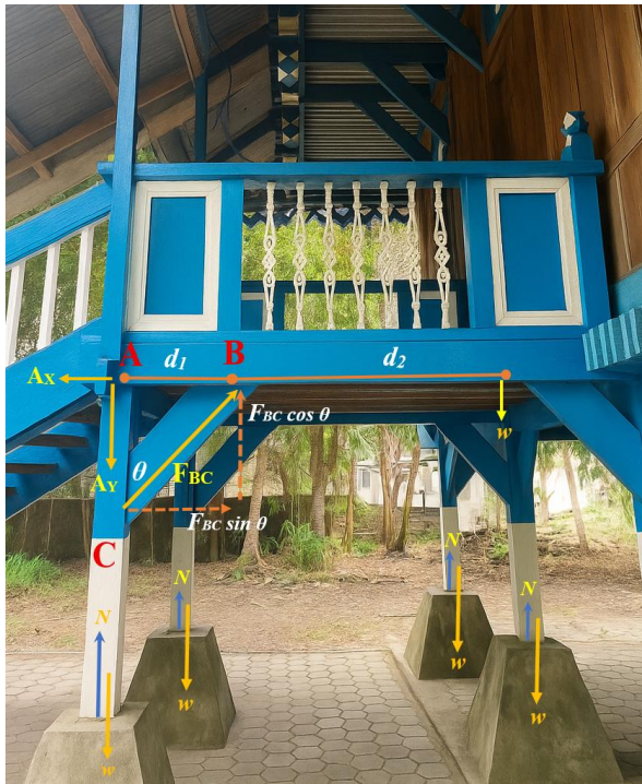
Gambar 3 Distribusi Beban dan Gaya Tumpuan pada Struktur Penopang
